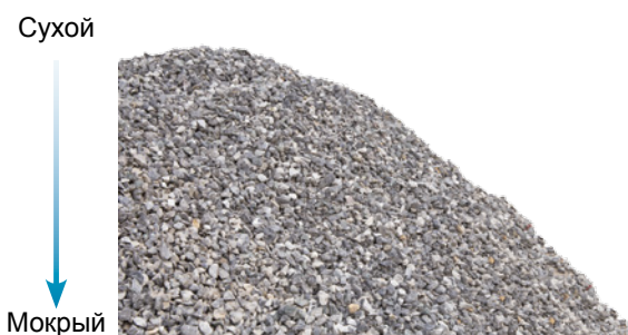
Рисунок 1: Естественный дренаж влаги в отвале заполнителя
