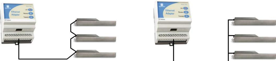
Рис. 22: Правильно выполненные кабельные соединения сети RS485
