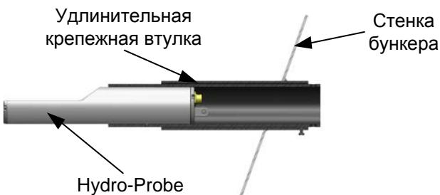
**Рис. 17. Датчик Hydro-Probe, установленный в удлинительной крепежной втулке**
